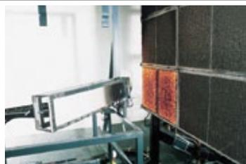
B2) La combustion débute mais la propagation de la flamme est fortement ralentie par le vernissage ignifuge.
