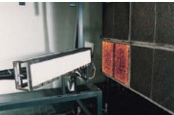
A) Début du test sur MDF verni avec un cycle polyuréthane normal.
